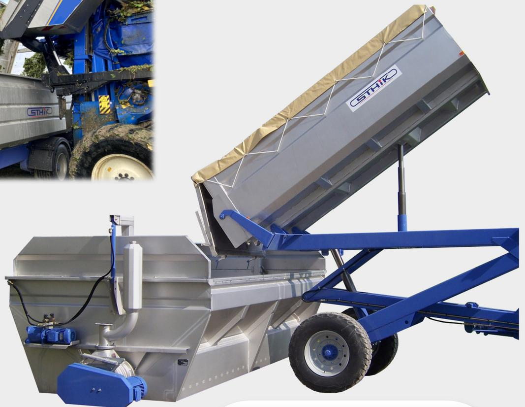
Déchargement en Hauteur avec Châssis Elévateur
