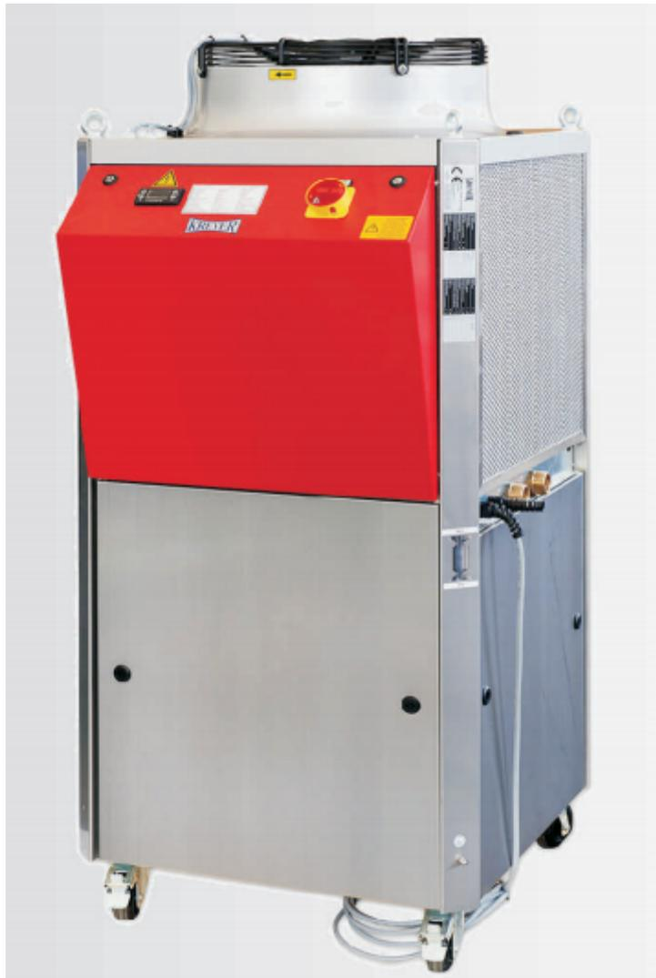
Chiller, wytwornica wody lodowej MCK składa się z jednostki chłodzącej w górnej części i pompy plus izolowanego zbiornika na wodę (wykonanego ze stali nierdzewnej) w dolnej części. Jednostka jest wygodnie zbudowana na ramie z wyjmowanymi panelami bocznymi, co umożliwia łatwy dostęp do wewnętrznych podzespołów. Wentylator jest montowany w górnej części jednostki, wydymując ciepłe powietrze do góry.
